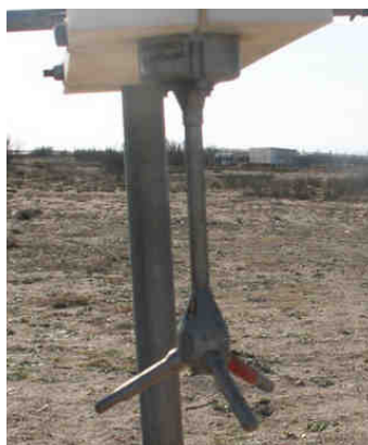
FIG. I.16 – Vue de l'extrémité d'un ADV et de ses 3 capteurs (source : F. Bouchette, campagne Leucate 2008).
