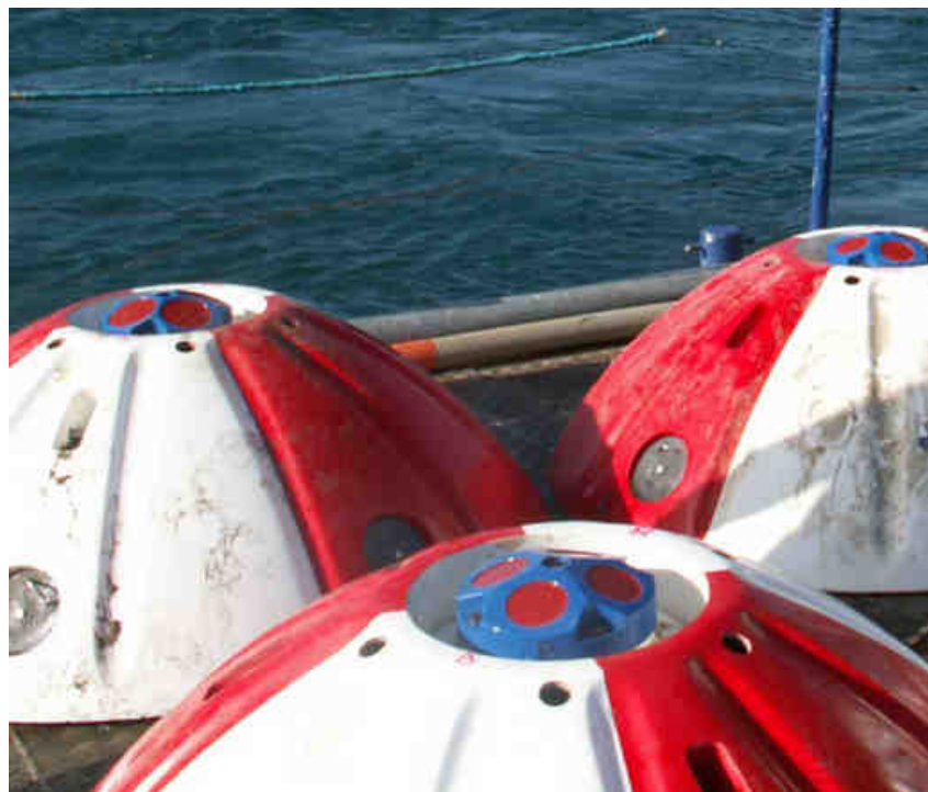
FIG. I.18 – Vue de trois ADCP insérés dans des cages anti-chalutage lestées. Les capteurs sont les cercles rouges dirigés vers le haut (source : F. Bouchette, campagne Leucate 2008).
