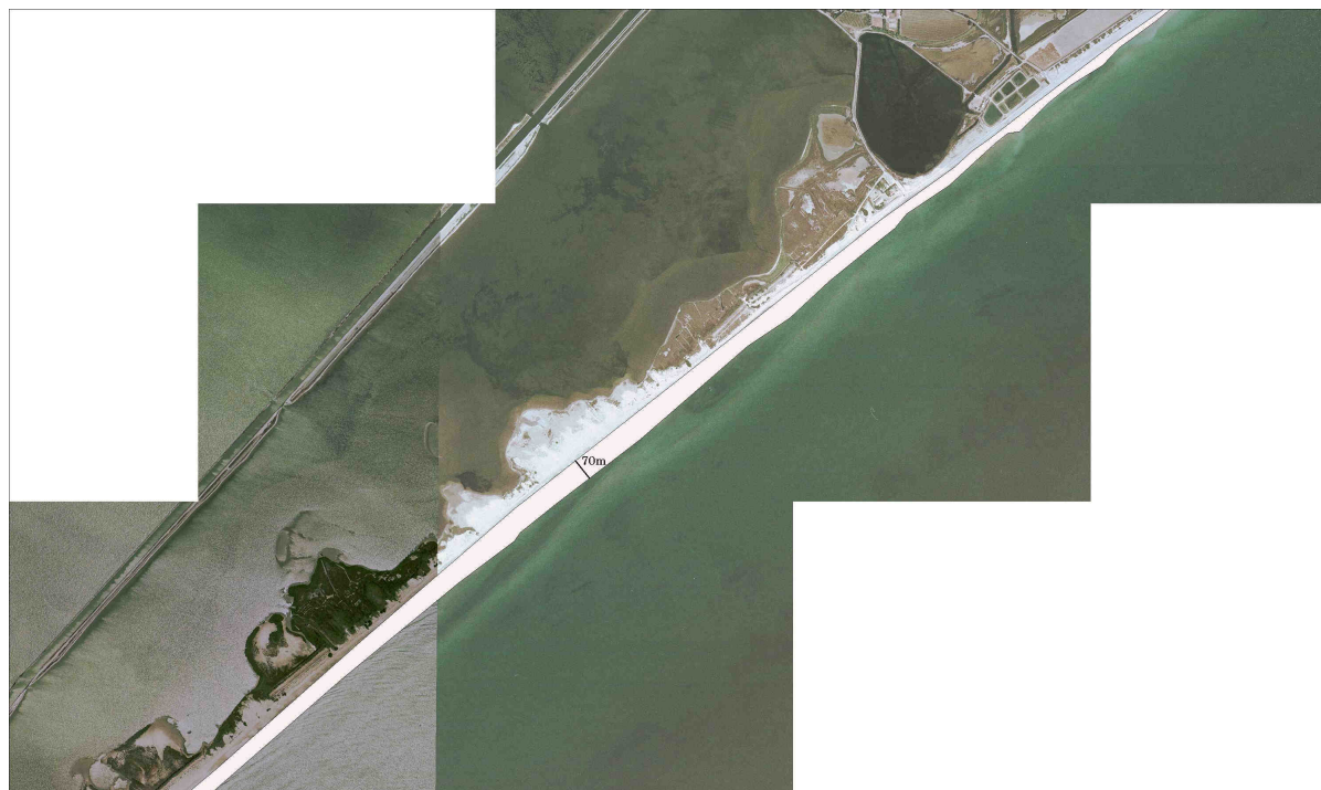
FIG. I.3 – Orthophotographie du lido de Villeneuve-lès-Maguelone (source : IGN). La portion de plage émergée ayant disparue par érosion entre 1962 et 2001 est indiquée par la surface en blanc. Des cônes de débordement de tempêtes sont visibles coté étang.
