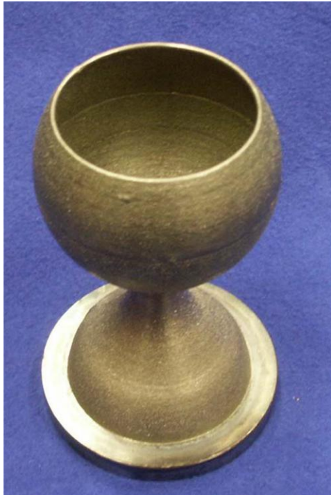
Figure 28. Exemple de pièce combinant dépôt de poudre et usinage de finition sur une seule machine [KER04].
