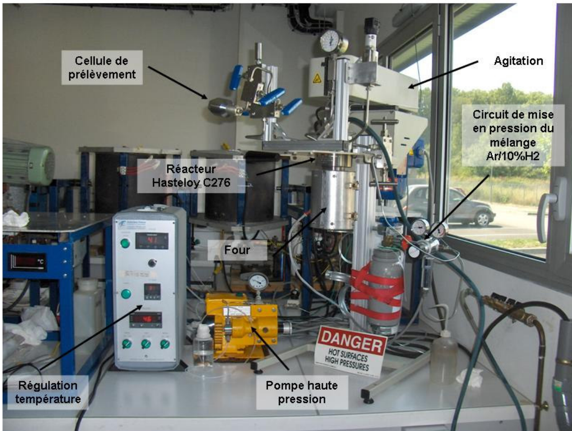
Figure III-1 : Photo du réacteur Autoclave Engineers en Hasteloy C276 et des systèmes connexes de régulation de la pression, de la température et de prélèvement.
