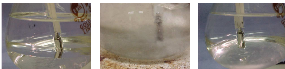
FIG. 1.6 – Mélange de méthanol ( \text{CH}_3\text{OH} ) et d'hexane ( \text{C}_6\text{H}_{14} ) dans les proportions de molécules 0.435 : 0.665. De gauche à droite, T < T_c , T \approx T_c et T > T_c . Pour T < T_c un ménisque sépare les composés qui ne sont pas miscibles. Pour T > T_c les composés sont miscibles et forment une seule phase. Pour T \approx T_c , le mélange devient flou. Les fluctuations de la densité entraînent une variation de l'indice de réfraction : les rayons lumineux sont déviés (photo d'après le site web [Pode], avec permission de l'auteur).
