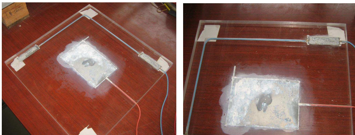
Figure V.13. Plaque utilisée pour le test en PCAS, après 1 mois dans le bac
