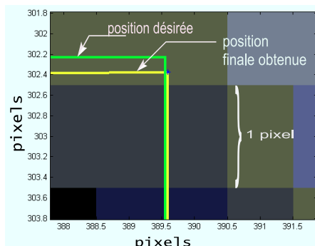
FIG. 5.15 – Illustration de la précision sub-pixellique lors d’un positionnement.
