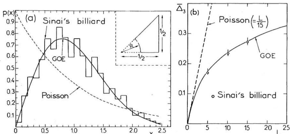
FIG. 1.5 – Propriétés statistiques d'un spectre d'un billard quantique chaotique dont la forme est donnée en insert. A gauche la distribution des écarts entre plus proches niveaux  $P(s)$ . A droite la rigidité spectrale  $\Delta_3$ , montrant les corrélations à longue distance dans le spectre. Les figures sont extraites de la référence [3].
