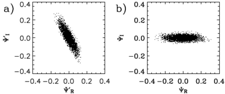
FIG. 1.16 – La répartition dans le plan complexe de la composante spatiale du champ électrique, noté  $\Psi$ , mesuré dans une cavité électromagnétique chaotique [92]. A gauche avant la rotation de phase qui rend les parties réelle et imaginaire indépendantes. A droite, après la rotation de phase.
