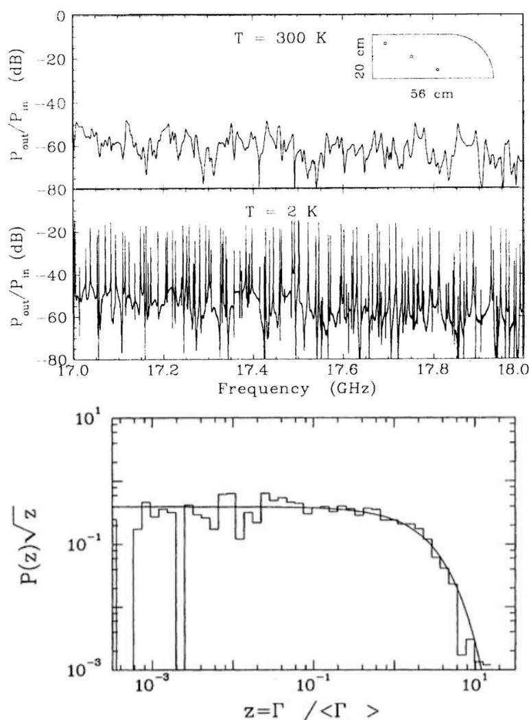
FIG. 1.9 – La première figure montre le spectre de la cavité électromagnétique en forme de quart de stade (voir insert), en haut à température ambiante en bas à  $T = 2.17$  K [63]. La seconde figure montre la distribution des largeurs  $z$  normalisées  $\langle z \rangle = 1$  dans le cas d'un seul canal de couplage [64]. En histogramme, les résultats expérimentaux obtenues avec une cavité électromagnétique supraconductrice, en trait plein la prédiction théorique.
