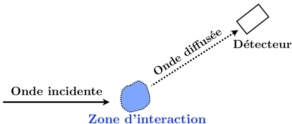
FIG. 1.6 – Schéma d'un processus de diffusion.
