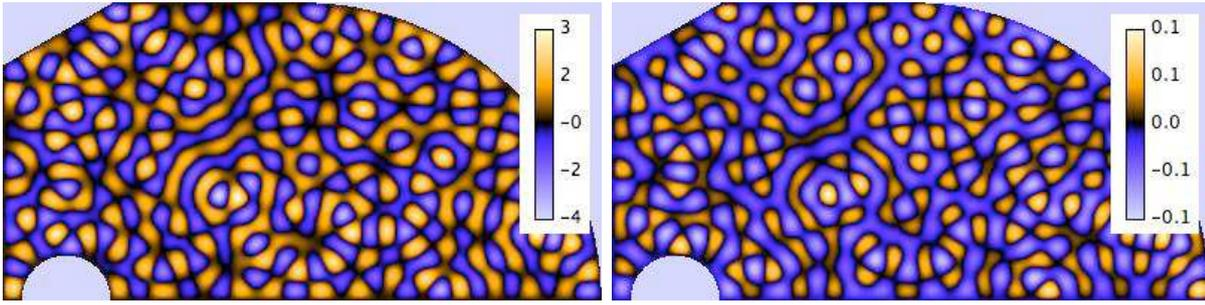
FIG. 4.2 – Champ complexe associé à la 500<sup>ième</sup> résonance pour une position du mélangeur et pour l'angle  $\alpha_{abs} = \pi/2$ . A droite la partie réelle et à gauche la partie imaginaire.
