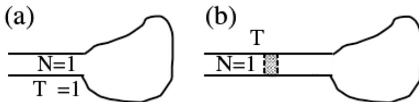
FIG. 1.12 – A gauche, une cavité attachée à un canal idéal ( $T = 1$ ). A droite, une cavité attachée à un canal non idéal ( $T < 1$ ), l'onde a une probabilité  $1 - T$  d'être directement réfléchi sans pénétrer dans la cavité.
