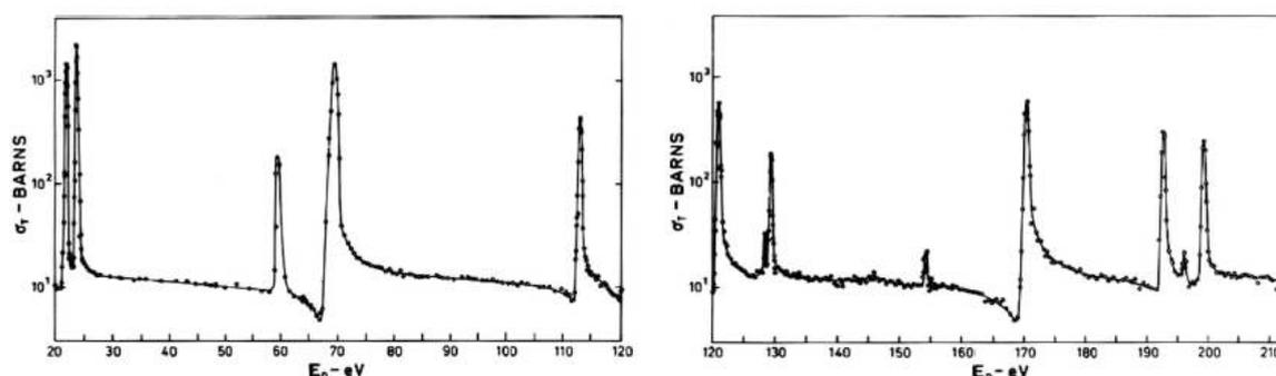
FIG. 1.1 – Le spectre du Thorium  $^{232}\text{Th}$  en fonction de l'énergie cinétique du neutron incident. Les pics indiquent la présence d'états liés de longue durée de vie. Les figures sont extraites de la référence [21].
