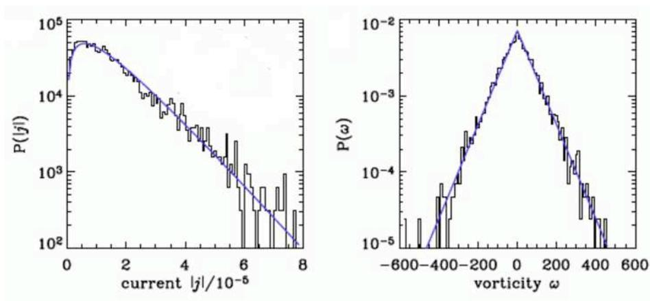
FIG. 1.20 – A gauche, distribution du module de la densité de probabilité du courant  $j$ . A droite la distribution de la vortacité. En traits pleins, les prédictions théoriques (1.36). En histogrammes, les résultats expérimentaux obtenus sur une cavité électromagnétique ouverte. Les figures sont extraites de la référence [92].
