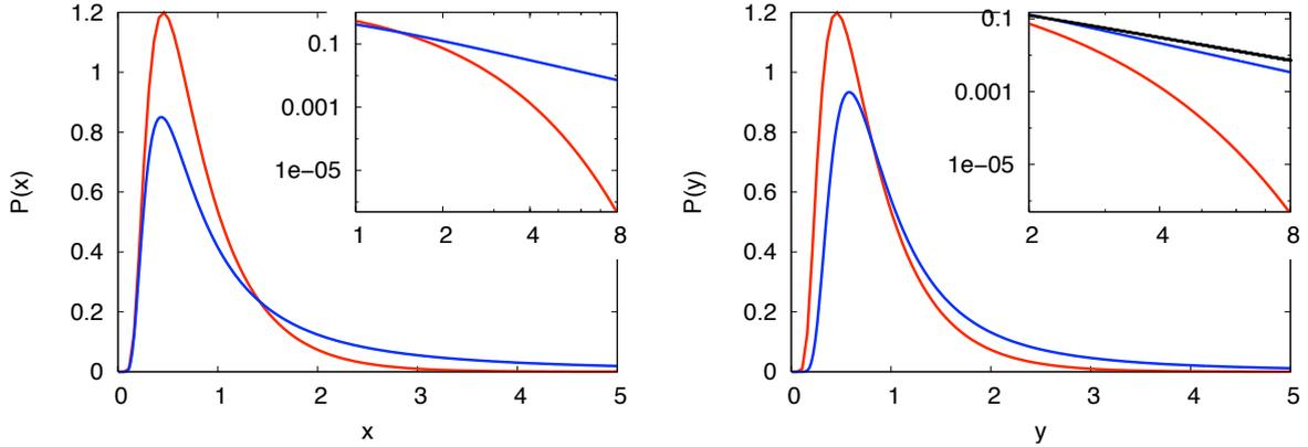
FIG. 3.16 – Distributions de probabilité du paramètre de non-orthogonalité normalisé  $x$  et  $y$ . A gauche pour picket-fence (3.103) en rouge et pour GOE (3.105). A droite pour picket-fence (3.103) en rouge, pour GUE (3.106) en bleu et pour GOE (3.106) en noir. En insert, les queues des distributions en échelle log-log.
