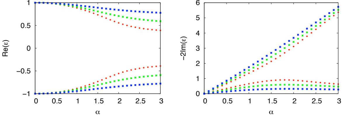
FIG. 2.9 – Evolution des énergies propres à gauche et des largeurs des résonances à droite en fonction du couplage  $\alpha$  pour  $E_2 = -E_1 = 1$ . En rouge pour  $\varphi = \pi/5$ , en vert pour  $\varphi = \pi/6$ , en bleu pour  $\varphi = \pi/8$ .
