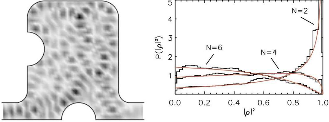
FIG. 1.18 – A gauche, l'intensité du champ électrique de la cavité ouverte par deux guides d'ondes pour une fréquence d'excitation. A droite, la distribution de la rigidité de phase pour  $N = 2, 4$  et  $6$  canaux fictifs (rappelons que le nombre de canaux correspond ici au nombre de modes transverses dans les guides et dépend donc de la fréquence d'excitation). Les figures sont extraites de la référence [99].
