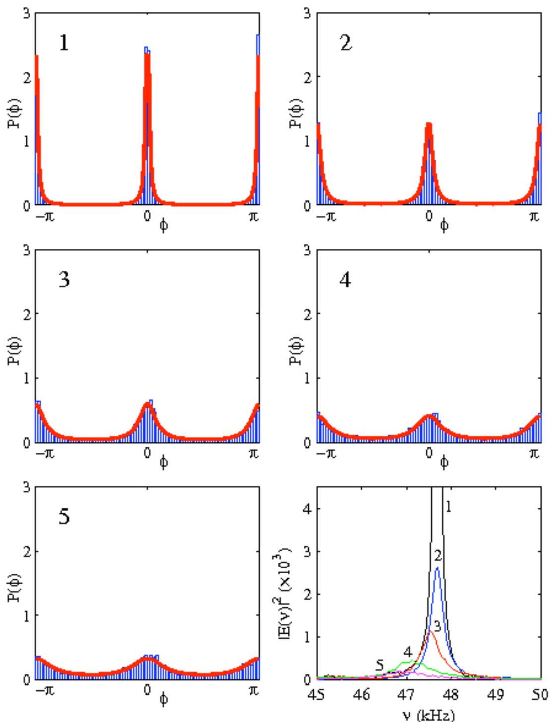
FIG. 4.8 – Distributions de probabilité de la phase  $P(\phi)$  pour les cinq configurations décrites précédemment, en haut à gauche sans absorption, en bas pour la plus grande absorption. En histogramme les résultats expérimentaux, en trait plein la distribution analytique (refPPPhase). En bas à droite est représenté les spectres correspondant aux différentes absorptions pour la résonance considérée.
