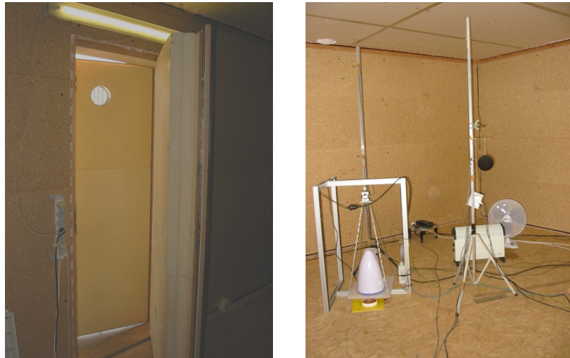
FIG. 2.5 : Vues de l'intérieur de la cellule : à gauche la double porte, à droite l'équipement
