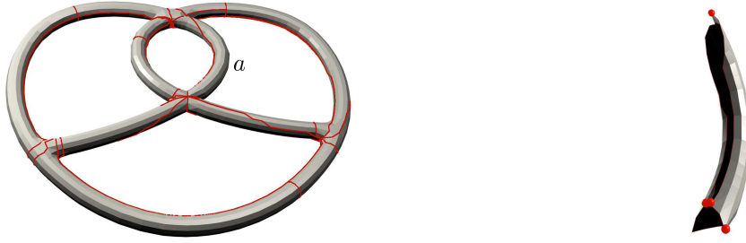
FIG. 5.10 – Gauche : quadrangulation après découpage topologique initial (algorithme 3.2) d'une surface de genre quatre. Droite : détail sur la tuile a à la géométrie médiocre.
