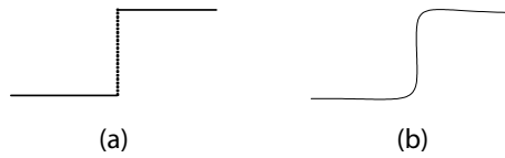
Fig. 3.8 – (a) Discontinuité que l'on attend ; (b) réalisation de la discontinuité présentée en (a) par un procédé classique de dépôt de résine par exemple.
