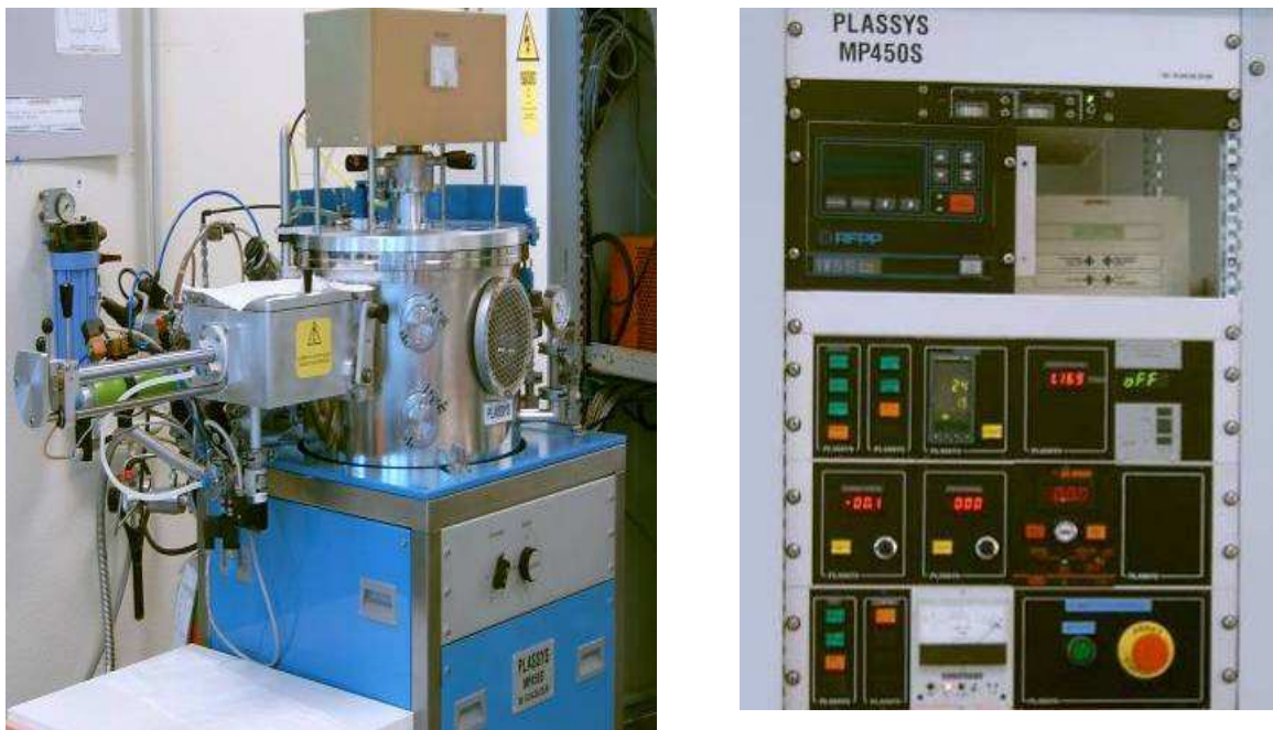
Figure 3.1. Photos du dispositif de dépôt par pulvérisation cathodique RF réactive de l'IUT de Saint Briec (Plassys MP450S).
