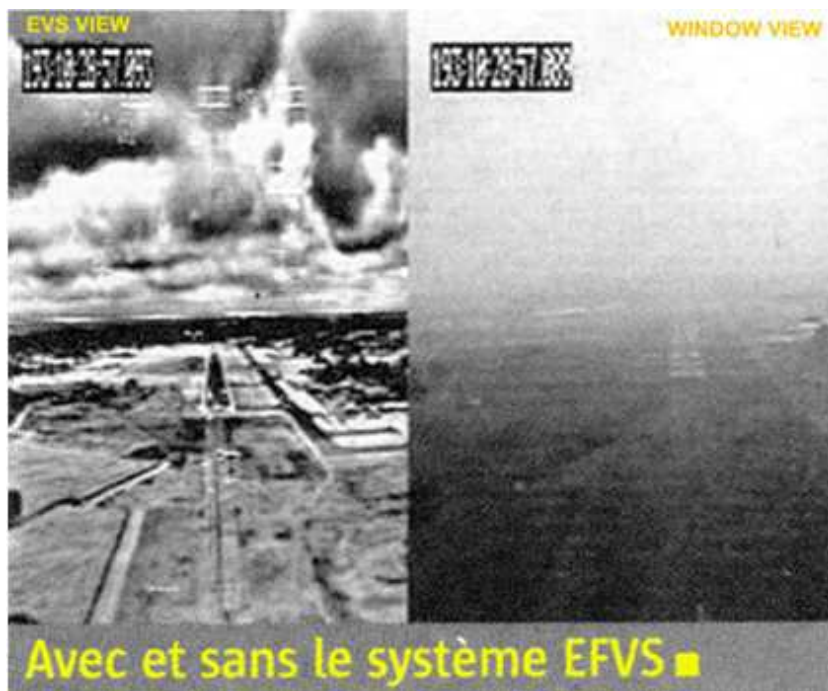
FIG. 1.5 – À gauche, système d'aide à l'atterrissage infrarouge, à droite champ de vision par temps de brouillard. Les gouttellettes d'eau en suspension qui diffusent dans le visible sont en revanche transparentes dans l'infrarouge.
