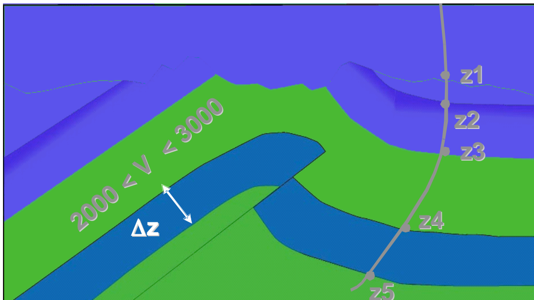
Figure II.14: Modèle géologique schématisé d'une ceinture de chevauchement comprenant la topographie. Les caractéristiques géométriques sont définies par des couches de fortes inclinaisons employées comme contraintes en tomographie de temps de trajet : ordre de grandeur des vitesses, épaisseurs, profondeurs (F. Delbos et al. , 2006).
