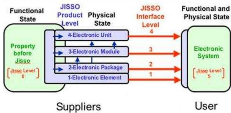
Figure 1.16. Hiérarchisation JISSO des niveaux d'interconnexions, d'assemblage et de packaging système complets pour les produits électroniques [JISSO]. (Bas) Vue schématique décomposée selon l'état fonctionnel, l'état physique (relatifs aux concepteurs/fabricants), et l'état combiné final (relatif aux utilisateurs du produit). (Haut) Vue matérielle de la hiérarchisation JISSO.
