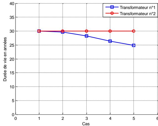
Figure 3-35 : Impact des harmoniques sur la durée de vie des transformateurs pour un courant efficace constant et les cas présentés dans le Tableau 3-2
