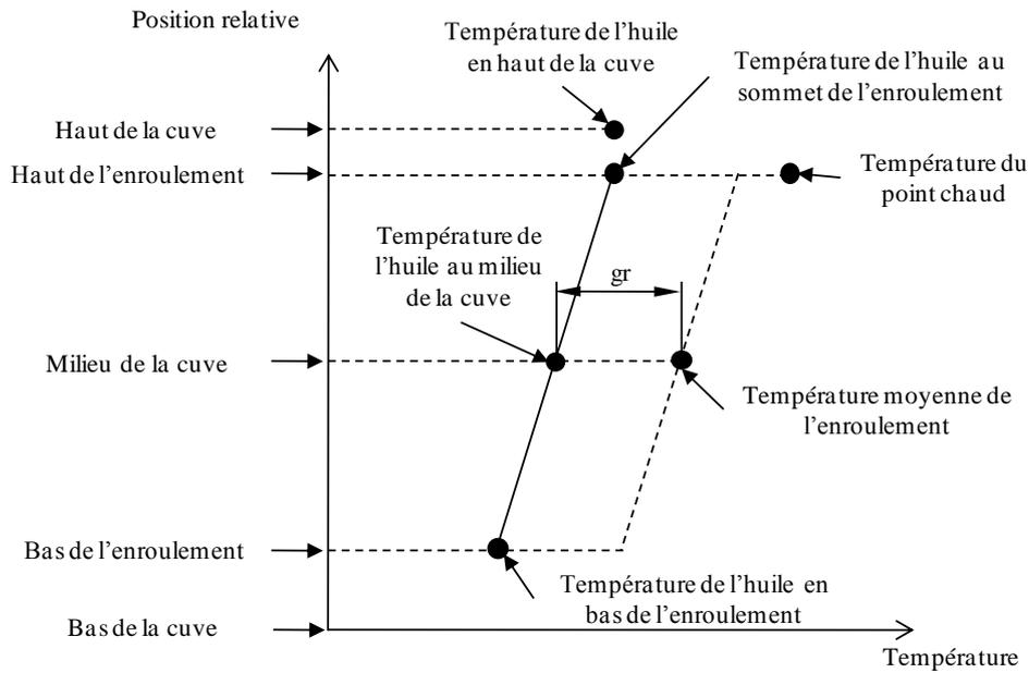
**Figure 3-14 : Diagramme thermique d'un transformateur à huile**
