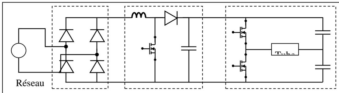
Figure 1-1 : Schéma d'un tube d'éclairage à ballast électronique
