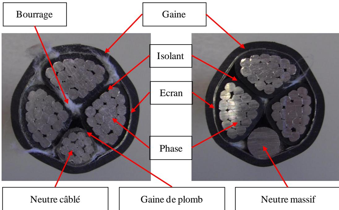
Figure 2-12 : Photographie des deux câbles basse tension utilisés pour les mesures (à gauche le câble à neutre câblé de 70 mm<sup>2</sup> et à droite le câble à neutre massif de 90 mm<sup>2</sup>)
