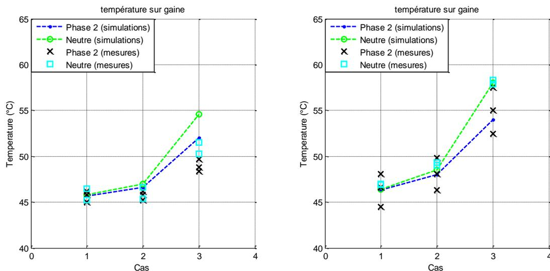
**Figure 2-18 : Températures de la gaine en face du conducteur de neutre et de la phase 2, obtenues par mesures et simulations pour les deux structures étudiées (Câble avec neutre massif à gauche - Câble avec neutre câblé à droite)**
