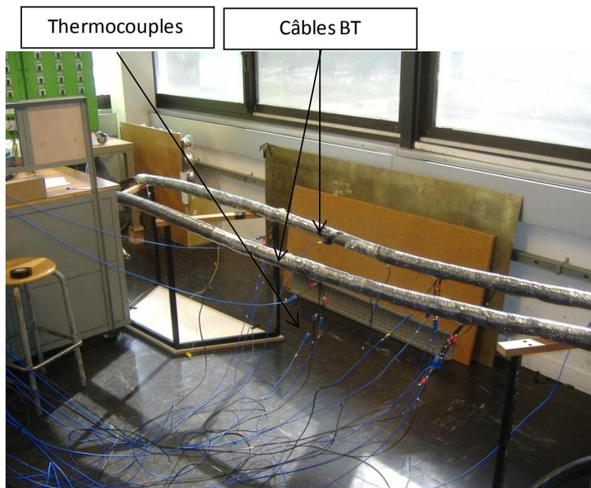
Figure C-1 : Installation des câbles et des thermocouples
