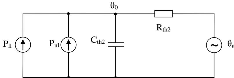
Figure 3-15 : Modèle thermique du transfert huile/air ambient
