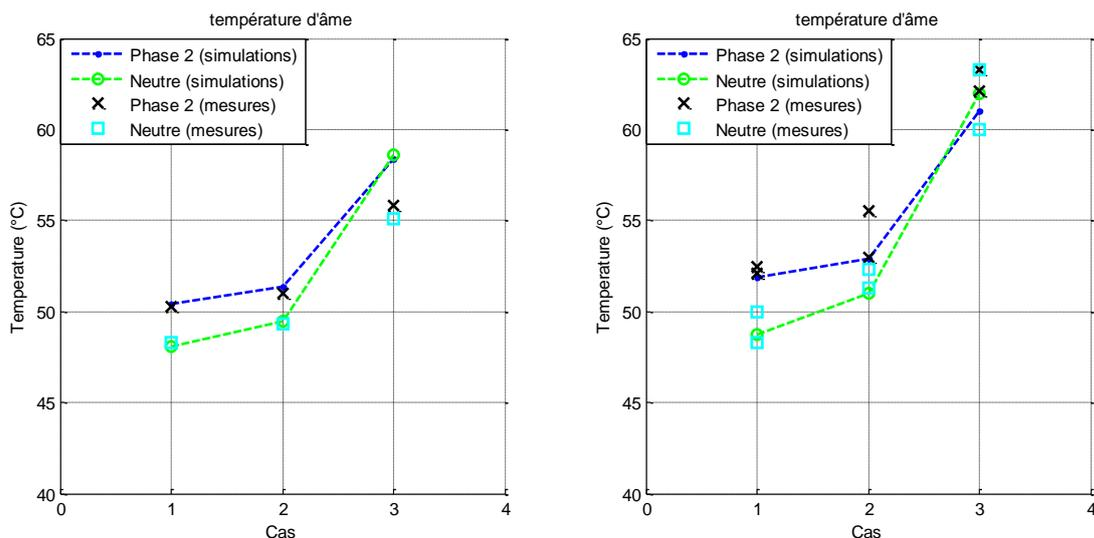
**Figure 2-17 : Températures de l'âme du conducteur de neutre et de la phase 2 obtenues par mesures et simulations pour les deux structures étudiées (Câble avec neutre massif à gauche - Câble avec neutre câblé à droite)**
