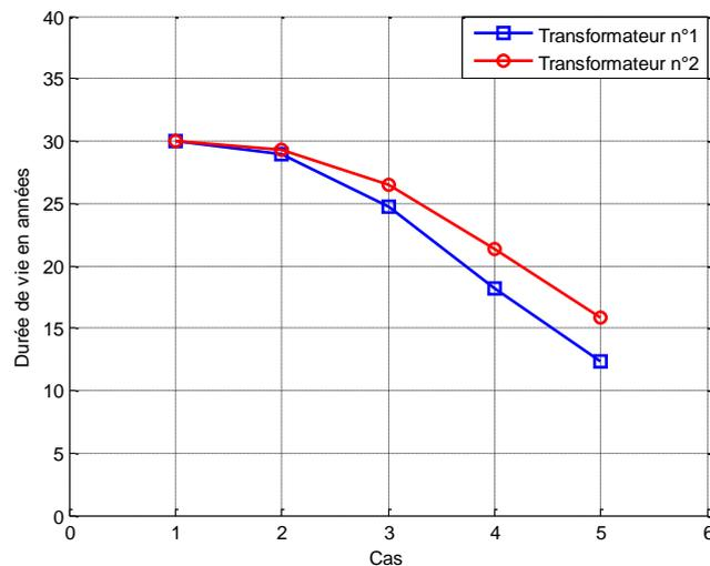
Figure 3-36 : Impact des harmoniques sur la durée de vie des transformateurs pour un courant fondamental constant et les cas présentés dans le Tableau 3-2
