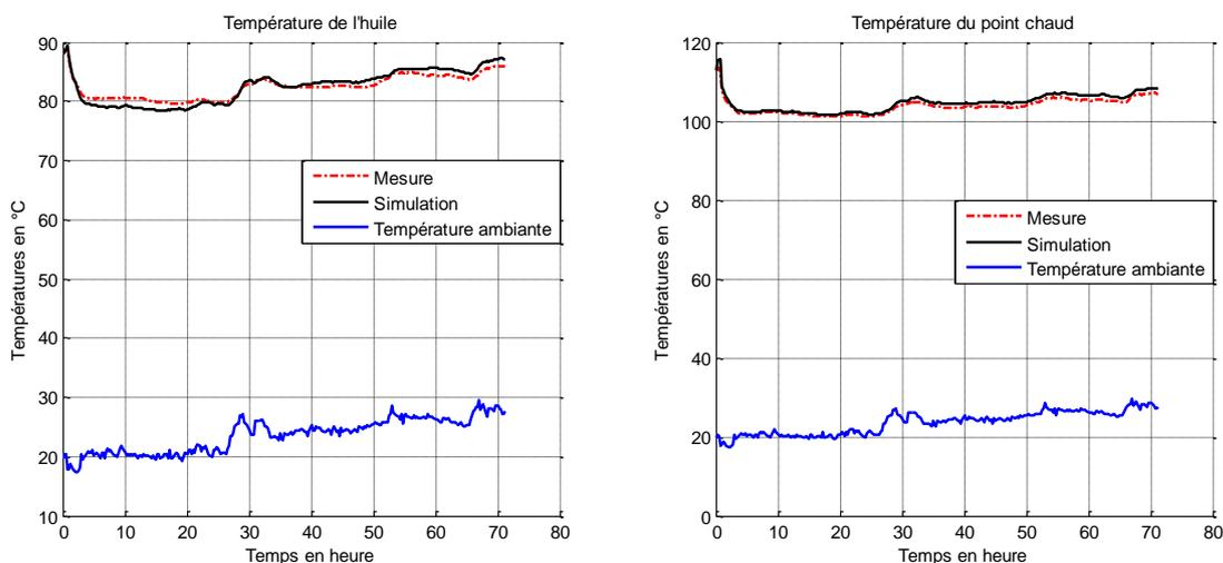
Figure 3-30 : Température ambiante, température mesurée et simulée de l'huile (à gauche) et du point chaud de l'enroulement (à droite) en fonction du temps (cas 2 -  $THD_i=10\%$ )
