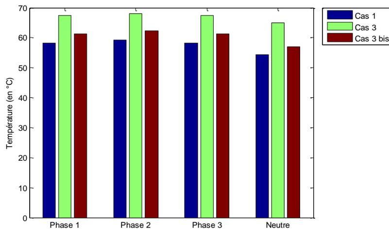
**Figure 2-9 : Evolution de la température d'âme des différents conducteurs**
