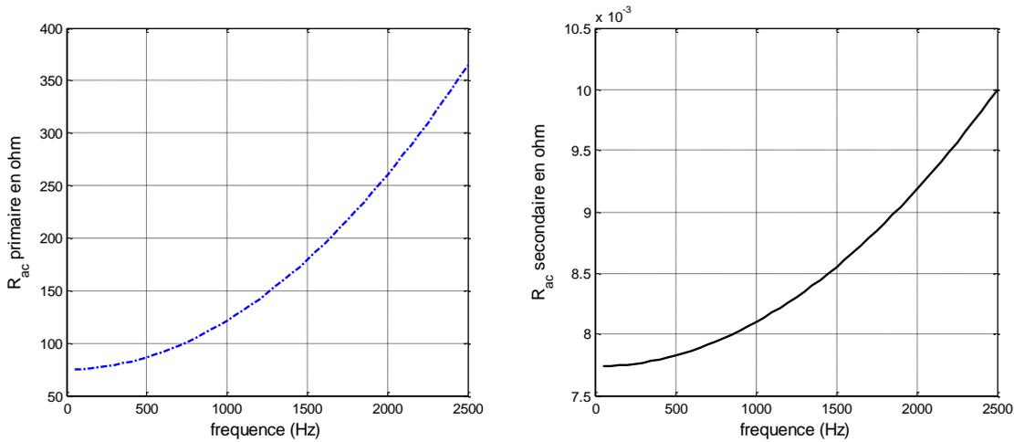
Figure 3-26 : Evolution des résistances primaire (à gauche) et secondaire (à droite) des enroulements du transformateur en fonction de la fréquence
