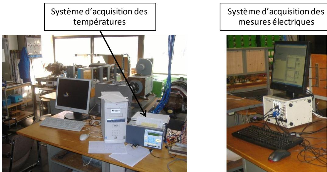
Figure C-3 : Système d'acquisition thermique (gauche) et électrique (droite)
