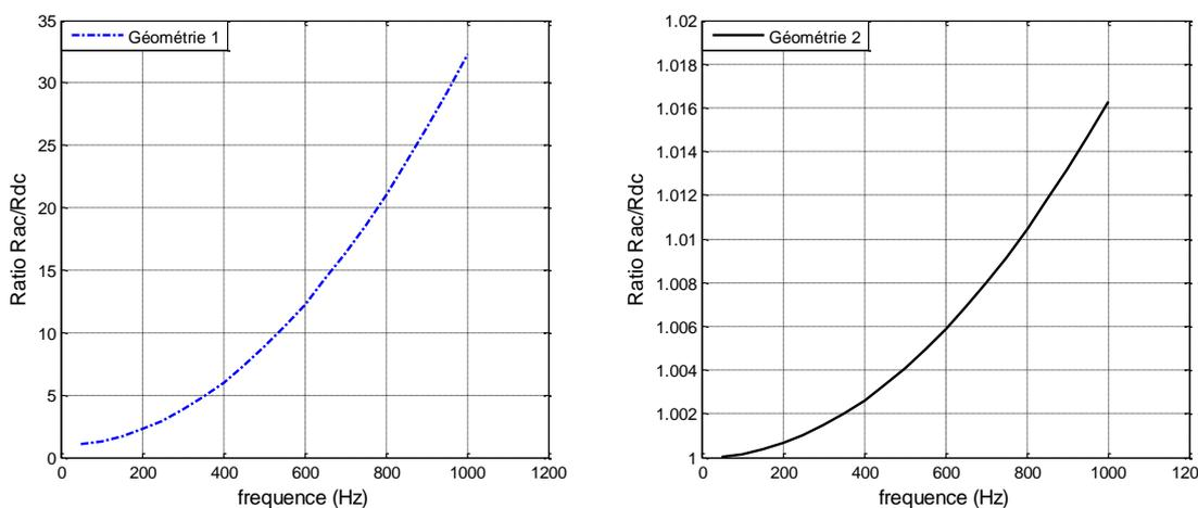
**Figure 3-8 : Evolution du rapport  $R_{ac} / R_{dc}$  de l'enroulement secondaire en fonction de la fréquence (à gauche transformateur n°1 avec des conducteurs rectangulaires - à droite transformateur n°2 avec des feuilles de cuivre)**
