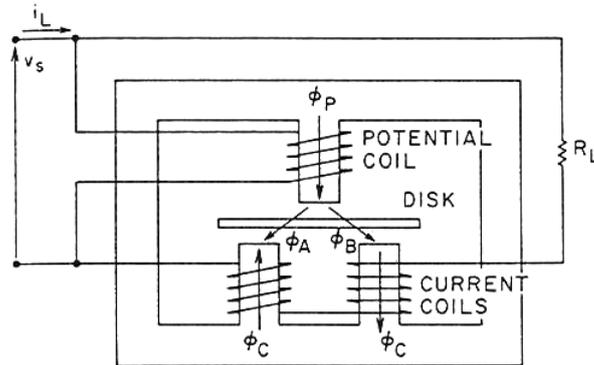
Figure 1-6 : Circuit magnétique d'un wattmètre à induction
