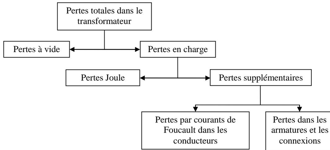
Figure 1-7 : Diagramme des pertes d'un transformateur
