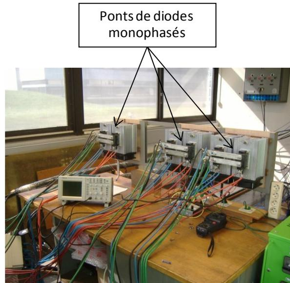
Figure C-2 : Ponts de diodes monophasés
