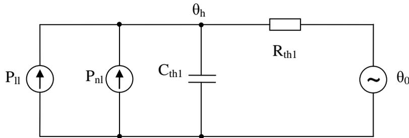
Figure 3-16 : Modèle thermique du transfert enroulement/huile
