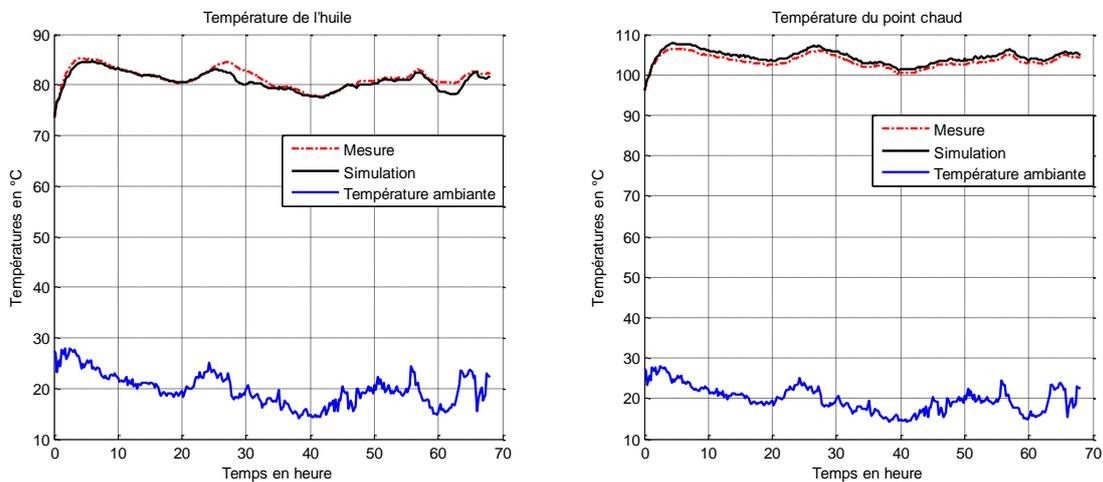
Figure 3-32 : Température ambiante, température mesurée et simulée de l'huile (à gauche) et du point chaud de l'enroulement (à droite) en fonction du temps (cas 4 -  $THD_i=62\%$ )
