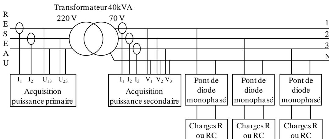
Figure 3-11 : Description de la plateforme d'essais
