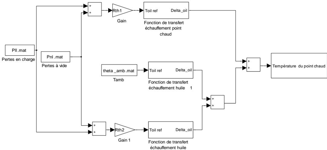
Figure B-3 : Schéma Simulink basé sur le modèle circuit simple
