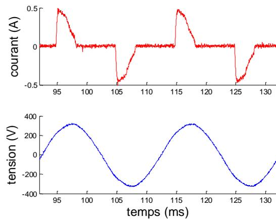
Figure 1-5 : Tension et courant absorbés par une lampe basse consommation 2×15W-230 V (mesures)
