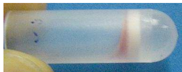
Fig 4.39 - Gel d'émulsion contenant un mélange binaire d'alcane 60% C_{12} – 40% C_{22} , ayant subi une centrifugation à froid à 30 000 rpm pendant une heure. Après avoir ôté l'huile libérée, il reste un gel rose intense dû à une concentration élevée en gouttes.
