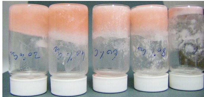
Fig 2.30 – Mélange d'alcane refroidi de 45°C à 0°C dans la glace. Une fois partiellement cristallisé, les mélanges ne coulent plus sous leur propre poids. De gauche à droite : 20% C_{22} ; 40% C_{22} ; 60% C_{22} ; 80% C_{22} ; 100% C_{22} .
