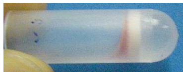
Fig 4.39 - Gel d'émulsion contenant un mélange binaire d'alcane 60% C_{12} – 40% C_{22} , ayant subi une centrifugation à froid à 30 000 rpm pendant une heure. Après avoir ôté l'huile libérée, il reste un gel rose intense dû à une concentration élevée en gouttes.
