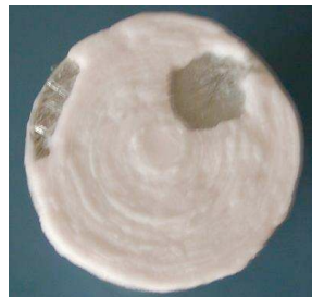
Fig 4.15 - Emulsion contenant un mélange binaire d'alcane 20% C 12 – 80% C 22 , refroidie à 0°C à 0,5°C/min, puis cisillée jusqu'à \gamma_m = 100 . L'échantillon garde une texture homogène. Les trous dans le gel sont dus à la séparation des géométries : le reste de l'échantillon se trouve sur l'autre partie de la géométrie.
