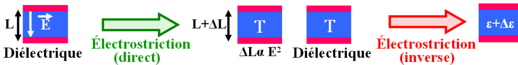
FIG.2-35 : Effet électrostrictif direct et inverse dans un diélectrique
