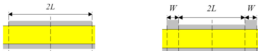
FIG.1-24: Coupe suivant le plan XZ d'un résonateur (on montre uniquement la couche piézoélectrique et les deux électrodes) (a) sans cadre et (b) avec cadre
