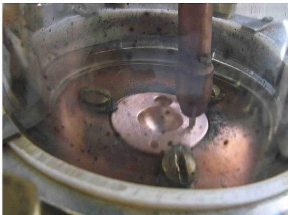
FIGURE 2.1 – Enceinte du four à arc utilisé, avec l'électrode et le creuset.
