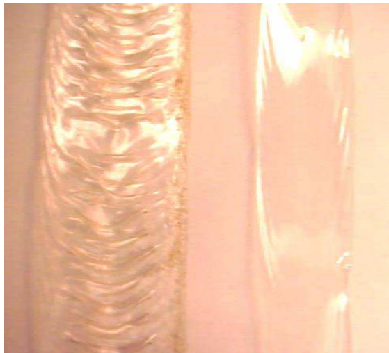
Figure 29: Photographie des films de UDEL P3500 extrudés à 0,5 mm.s -1 , à 400°C (à droite), et 300°C (à gauche)
