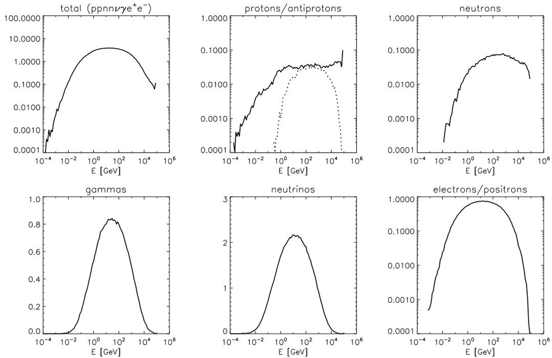
FIGURE 2.9 – Histogrammes en énergie des particules secondaires produites lors de l’interaction p-p calculés avec le code EPOS, avec un projectile d’énergie  $E_p = 10^5$  GeV. En ordonnées : le nombre de particules dans chaque intervalle d’énergie normalisé pour une seule interaction. La ligne pointillée donne le nombre d’antiprotons.
