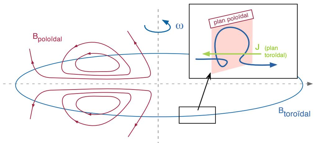
FIGURE 3.7 – Illustration schématique de l’effet dynamo  $\alpha\omega$  (adapté de Kronberg 1994). L’encadré en haut à droite décrit l’effet  $\alpha$  : les boucles de champ toroïdal sont vrillées par l’effet Coriolis. Ceci induit un courant  $J$  dans le plan toroïdal.
