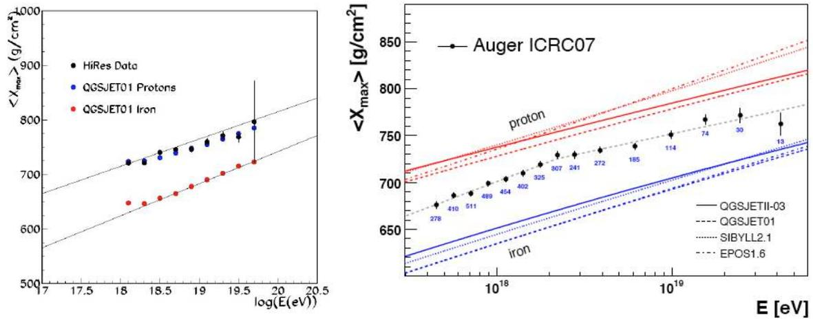
FIGURE 1.13 – Mesures du taux d'élongation de la gerbe  $X_{\max}$  par l'expérience HiRes (à gauche, J. Belz, présentation de CRIS 2008) et l'Observatoire Pierre Auger (à droite, Unger et al. 2007). Les données sont comparées aux valeurs obtenues par des simulations de gerbes pour le cas pur proton et pur fer.
