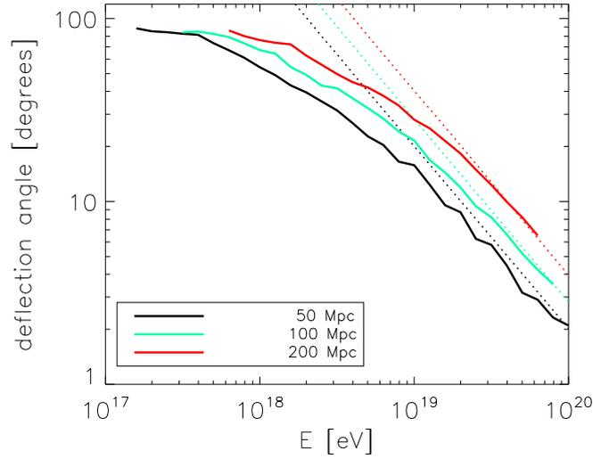
FIGURE 4.9 – Angles de déflexion moyens à différentes distances de la source, en fonction de l’énergie de la particule. Les traits pleins donnent les résultats de nos simulations avec  $\tilde{B} = 2$  nG et  $\lambda_B = 300$  kpc, pour le modèle “isotrope” (équation 3.24). Les tirets donnent les valeurs analytiques calculées par Waxman & Miralda-Escudé (1996) (équation 4.6).
