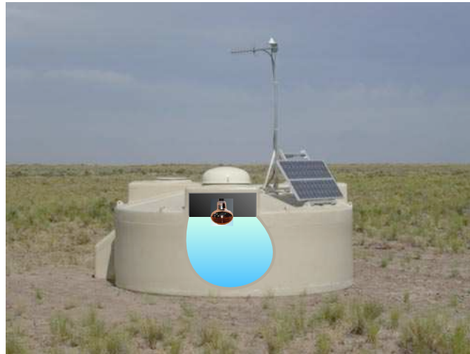
FIGURE 1.2 – Vue d’artiste de l’intérieur d’une cuve Čerenkov de l’Observatoire Pierre Auger. Les scintillateurs ou cuves Čerenkov sont des cuves contenant une quantité importante d’eau pure. Lorsqu’une particule chargée pénètre dans le liquide avec une vitesse supérieure à la celle de la lumière dans le milieu, un rayonnement électromagnétique est émis (effet Čerenkov). Ces photons sont diffusés puis réfléchis sur les parois de la cuve avant d’être collectés par un photomultiplicateur placé au-dessus de l’eau.
