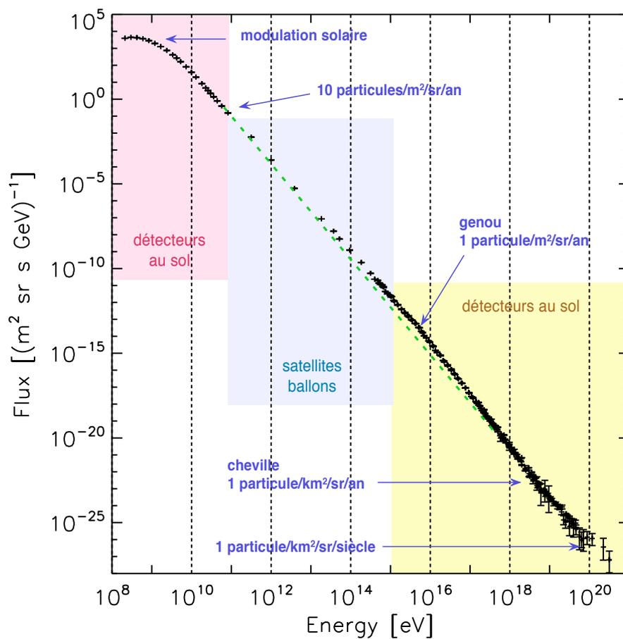
FIGURE 1.1 – Le spectre observé des rayons cosmiques pour les énergies supérieures à 1 GeV. Il s'agit du flux différentiel  $dN/(dE dA d\Omega dt)$ , où  $N$  est le nombre de particules collectées,  $A$  et  $\Omega$  la surface et l'angle solide de détection, et  $t$  la durée de la mesure, en fonction de leur énergie. Les tirets verts indiquent une loi de puissance en  $E^{-2.7}$ . Nous avons utilisé pour cette figure les données de différentes expériences compilées par S. Swordy.
