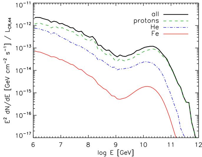
FIGURE 6.9 – Flux de neutrinos pour un amas à cœur froid avec un champ magnétique au centre de  $B_c = 10 \mu\text{G}$  et une source centrale injectant une composition mixte avec  $L_{cr} = 10^{44}$  erg/s, à une distance de 100 Mpc et pour un indice spectral de 2.3. La contribution des protons primaires (tirets verts), de l’hélium (tirets-points bleus) et du fer (trait plein rouge) sont indiquées.
