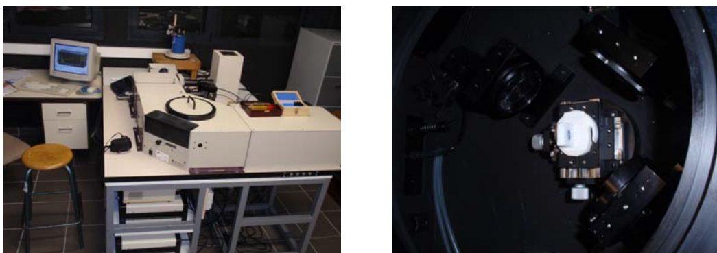
Figure 17 – Spectrofluorimètre Edhinburg FSL900 (IPREM Pau)
