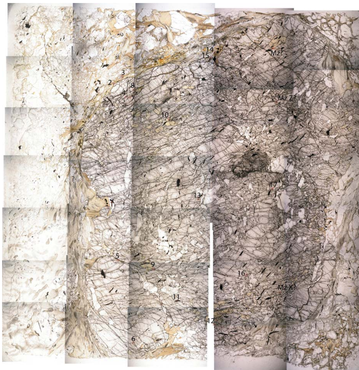
Figure V-12 : Exemple d'une lame mince (YY20) de grenat hélicitique contenant des monazites. Cette image est reconstituée à partir d'une série de photographies de la lame mince sous microscope optique. Les numéros localisent des monazites.
