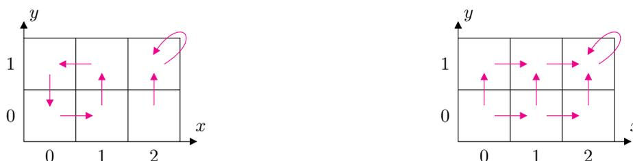
FIG. 3.7 – **Á gauche** : système de transitions ayant besoin des variables  $V$  pour vérifier l'existence d'un  $E[(x < 2)U(x = 2)]$ -chemin à cause du cycle  $(0, 0) \rightarrow (1, 0) \rightarrow (1, 1) \rightarrow (0, 1) \rightarrow (0, 0)$  qui est un  $((x < 2) \wedge \neg(x = 2))$ -chemin. **Á droite** : système de transitions n'ayant pas besoin des variables  $V$  pour vérifier l'existence d'un  $E[(x < 2)U(x = 2)]$ -chemin.
