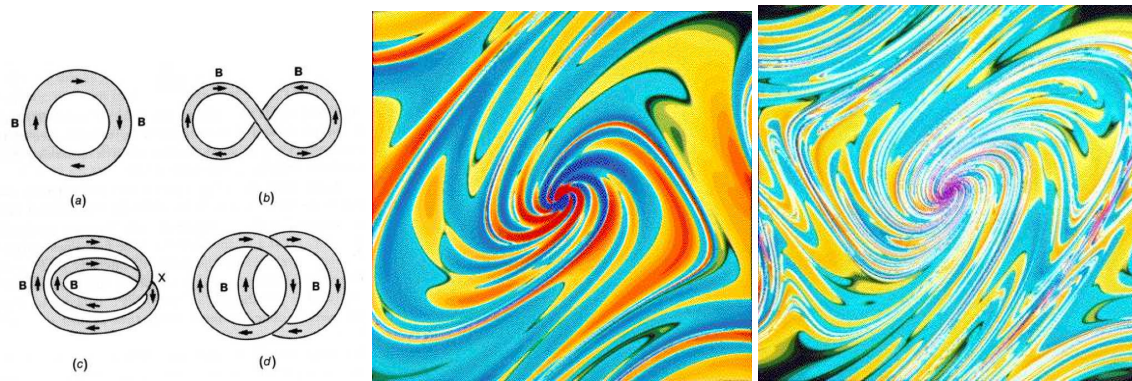
F . 2.2 – La dynamo rapide et le mécanisme de Stretch-Twist-Fold , les images montrent le champ magnétique évoluant dans une dynamo rapide dans un écoulement de Kolmogorov \mathbf{u} = (\sin z, \sin x \sin y) étudié pour la première fois par Galloway et Proctor (1992). Les 2 images correspondent à 2 instants différents de la simulation, la 2ème étant plus avancée.
