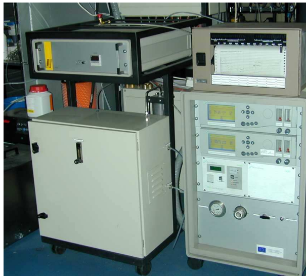
Figure III.3-1 : Analyseurs à IR non dispersifs et paramagnétique (à droite), avec préparateur de gaz (à gauche)
