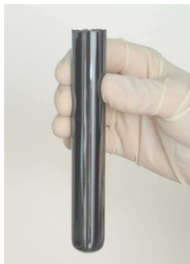
Figure 8 : Photographie d'un barreau de verre TeAsSe.
