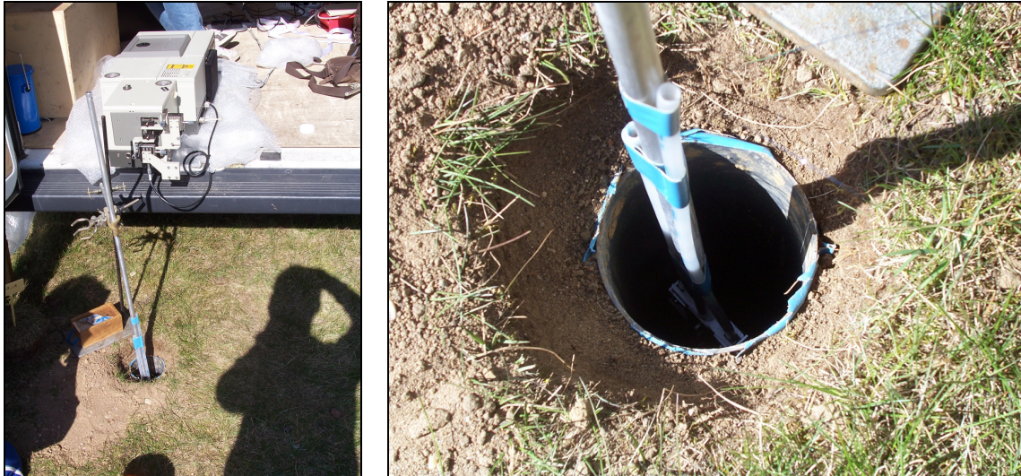
Figure 22 : Photos du capteur optique dans un puits pour une mesure de la concentration en CO 2
