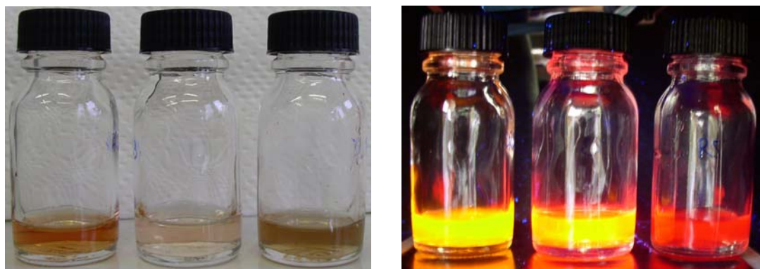
Figure VII-7: Photos des 3 tailles de cœurs de nanocristaux sous lumière ambiante (à gauche) et sous excitation ultraviolette ( \lambda_{\text{ex}}=365 \text{ nm} ) (à droite)
