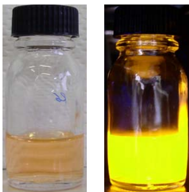
Figure VII-23: Photos des NCs de \text{Cd}_{1-x}\text{Zn}_x\text{Se} sous lumière ambiante et sous excitation UV ( \lambda_{\text{ex}}=365 \text{ nm} )
