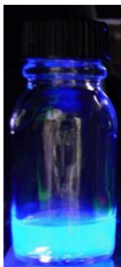
Figure III-9 : Photo des NCs de CdS/ZnS obtenus sous excitation UV ( \lambda_{\text{ex}}=365 \text{ nm} )
