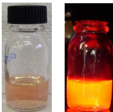
Figure VII-14: Photos des NCs de CdSe/CdS/ZnS sous lumière ambiante et sous excitation UV ( \lambda_{\text{ex}}=365 nm)
