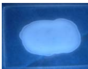
Figure V-13 : Mélange blanc incorporé dans du PMMA sous excitation UV ( \lambda_{\text{ex}}=400 nm).
