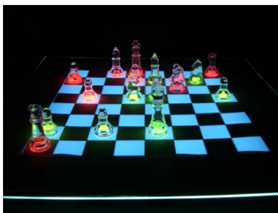
Figure II-22 : Jeu d'échecs où 2 tailles de NCs de CdSe/CdS/ZnS ont été incorporées dans du PMMA puis déposées à l'intérieur de pièces d'échec en verre. La photo présente l'échiquier obtenu éclairé par une lampe UV ( \lambda_{\text{ex}}=380 nm).
