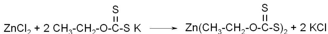
Équation II-7 : Réaction mise en jeu pour la synthèse de l'éthylxanthate de zinc
