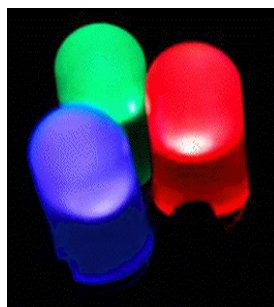
Figure V-4 : LEDs émettant respectivement dans le rouge, le vert et le bleu, permettant la génération de lumière blanche [1]
