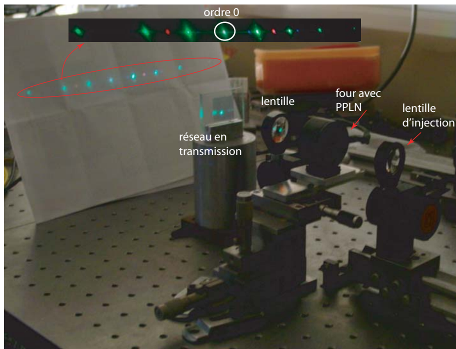
FIGURE 4.8 – Représentation de l'expérience de doublage de fréquence du laser dans le cristal PPLN.
