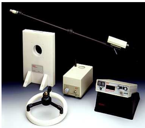
Figure 3-11 : L'appareil de mesure de la susceptibilité magnétique (Bartington).
