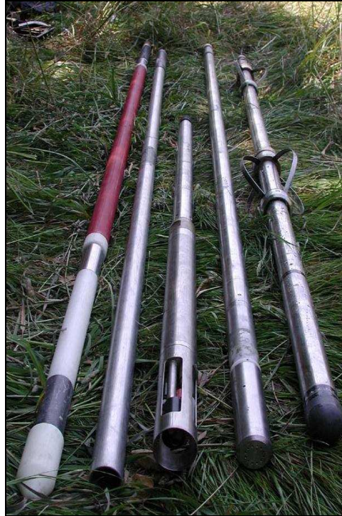
Figure 3-17: Sondes de mesures en forage, de la droite vers la gauche (ABI40, OBI40, IDRONAUT, ELXG, GLOG).
