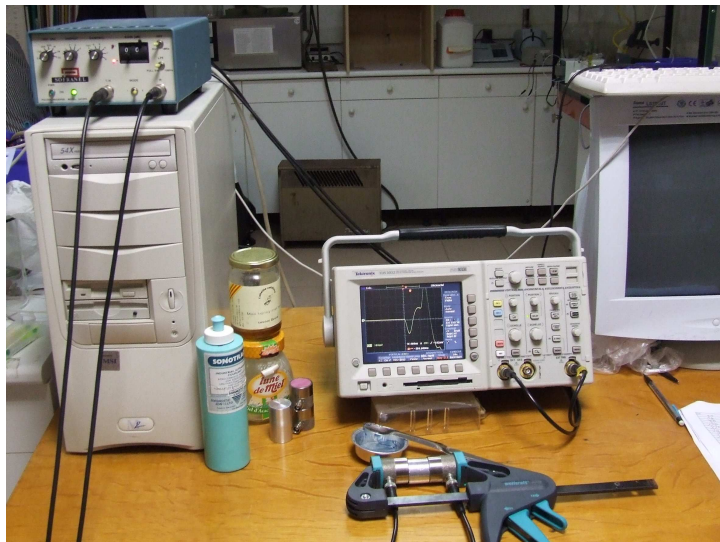
Figure 3-9: Dispositif expérimental de vitesse des ondes acoustiques (P et S).
