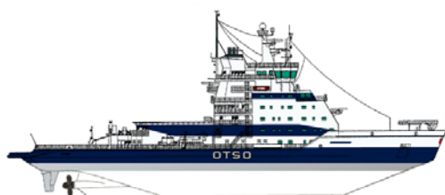
OTSO 1986 / KONTIO 1987 Shaft output 15000 kW
