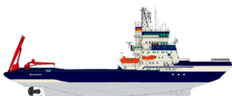
FENNICA 1993 / NORDICA 1994 Shaft output 15000 kW
