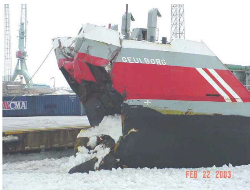
Photographie 33 – Dommages à l'avant d'un vraquier après collision, Golfe de Finlande Picture 33 – Bulk carrier bow damages after collision, Gulf of Finland (Source : Swedish Maritime Administration)
