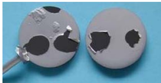
Figure V.15 : Photographie montrant les résultats des tests d'arrachement sur l'alumine de type 1
