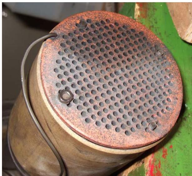
*Figure 4 : Vue extérieure de l'échangeur chaud déposé*
