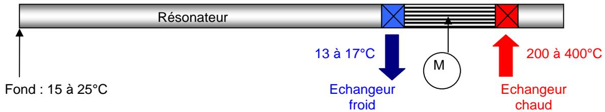
*Figure 101 : Schéma de principe du résonateur et du moteur thermoacoustique (« M cerclé ») avec les températures approximatives en fond de résonateur, au niveau de l'échangeur froid et chaud ; les plages de valeurs tiennent compte de toutes les séries de mesures, et pas uniquement à la 210406-Sonde*
