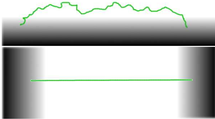
FIG. 9: Comparaison entre les géométries expérimentale et modèle. En haut : la géométrie expérimentale : une molécule d'ADN étirée à 70% et attachée par ses extrémités sur une surface réfléchissante. En bas : la géométrie utilisée dans le modèle : un cylindre entre deux surfaces réfléchissantes.
