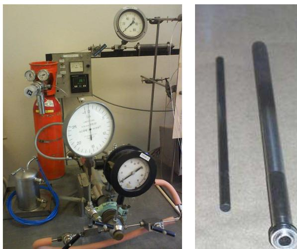
Figure 3.8 : Photographie d'un autoclave (à gauche), et d'un tube autoclave avec une barre de remplissage de volume mort (à droite)
