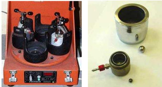
Figure 3.6 : Photographie du broyeur P5 (à gauche) et bols de broyage (à droite)
