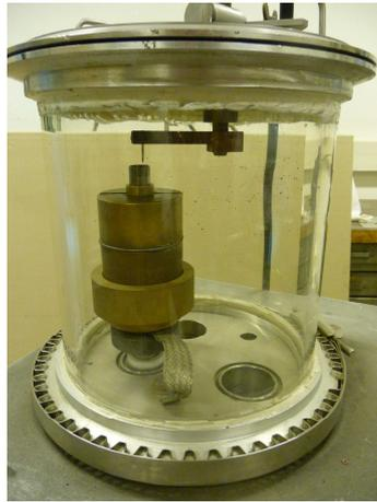
Figure 3.1 : Photographie du dispositif de scellement de tube de tantale par soudage sous argon
