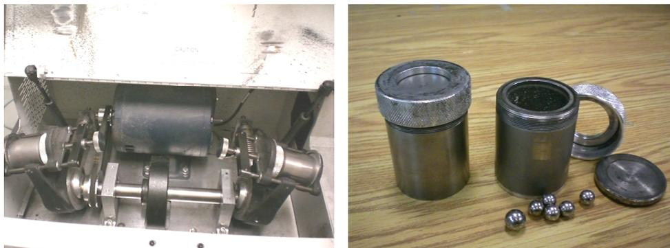
Figure 3.7 : Photographies du dispositif de broyage de type SPEX (à gauche) et des creusets et billes (à droite)
