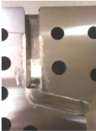
Figure 5.22 : Photographie de la tête ECAP ( $\Phi = 105^\circ$ ) lors d'une ouverture pour contrôle et nettoyage avec un barreau encore présent dans le canal de sortie
