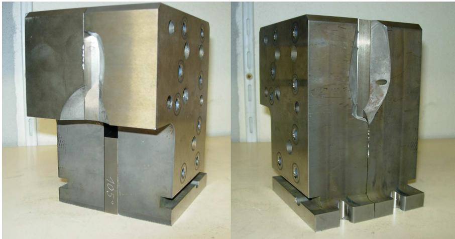
*Figure 5.3 : Photographies de la destruction du premier dispositif ECAP – face avant (à gauche) et face arrière (à droite)*
