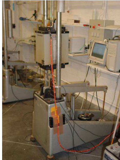
Figure IV-2: Banc de fluage équipé d'un four à résistances (banc FR)
