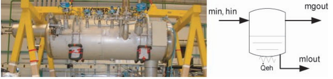
FIGURE 3.7 – Le séparateur de phase du thermosiphon de CMS et schéma du modèle avec les conditions limites
