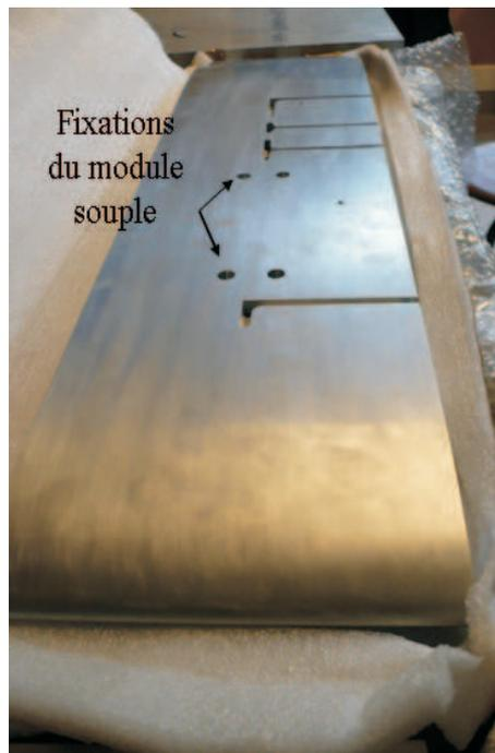
*Figure V.7* — Vue de dessous du support rigide
