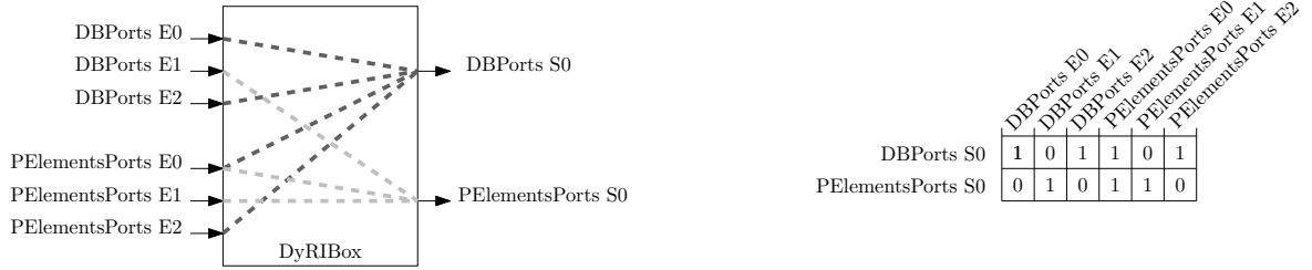
Figure 3-9 – Exemple de description de type AdjacencyMatrix . Dans cet exemple, la DyRIBox est composée de trois ports d'entrée et un port de sortie de type DBPorts , de trois ports d'entrée et un port de sortie de type PElementsPorts . La spécification de l'AdjacencyMatrix permet de restreindre les connexions possibles entre les entrées et les sorties.
