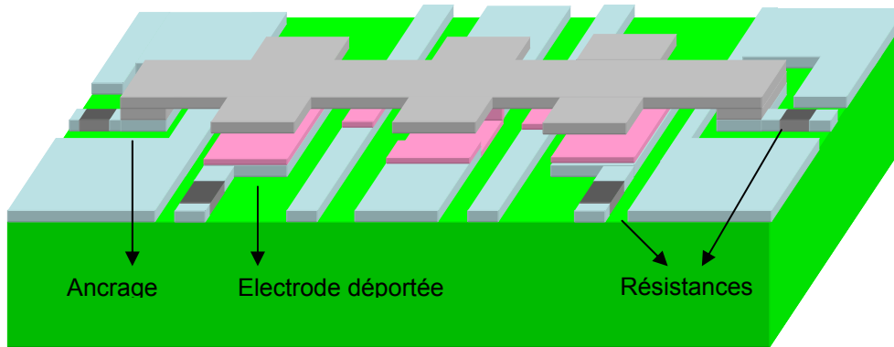
Figure II. 13: Schématisation d'un commutateur capacitif série avec électrodes déportées et résistances intégrées
