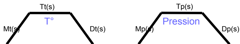
Figure III. 21 : Conditions et paramètres du report Flip-Chip
