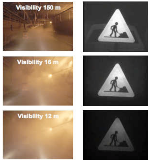
FIGURE 2.4 – Résultats obtenus par crénelage temporel
