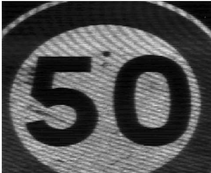
FIGURE 7.7 – Image ( 200 \times 200 ) obtenue avec un temps de balayage par ligne de 20\text{ ms}
