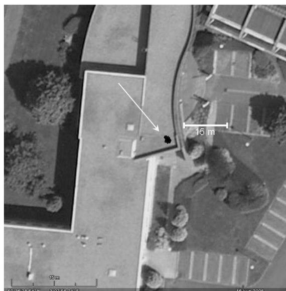
FIG. 2.11 – Exemple de positionnement GPS en milieu dégagé. Les positions ont été enregistrées sur le toit du bâtiment INRETS de Villeneuve d'Ascq. Le ciel est ici dégagé au dessus de  $5^\circ$  d'élévation.
