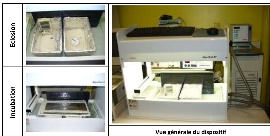
Figure 67 : Dispositif mis en place pour la réalisation de l'essai ostracode à 29 °C en France (Photo : Angerville, 2007)
