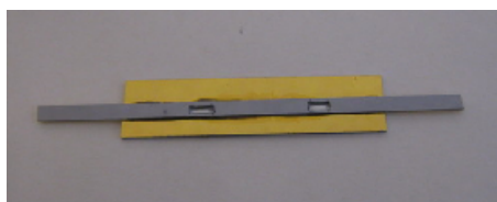
FIG. 6.23 – Photographie d'un dispositif électro-optique collé sur un support de silicium métallisé après gravure des ouvertures à la DRIE
