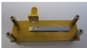
FIG. 6.25 – Photographie d'un dispositif à ondes localisées relié à un connecteur SMA
