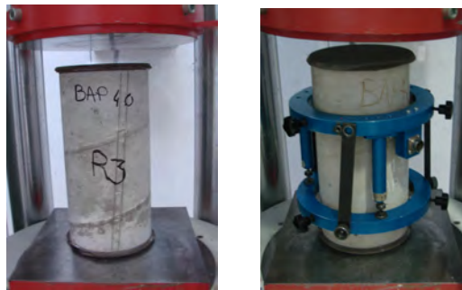
Figure 5.12 – Eprouvette mise en place sur la presse hydraulique pour déterminer la résistance à la compression et le module d'élasticité
