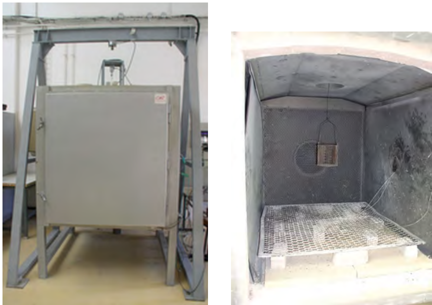
Figure 5.7 – Four utilisé pour les traitements thermiques
