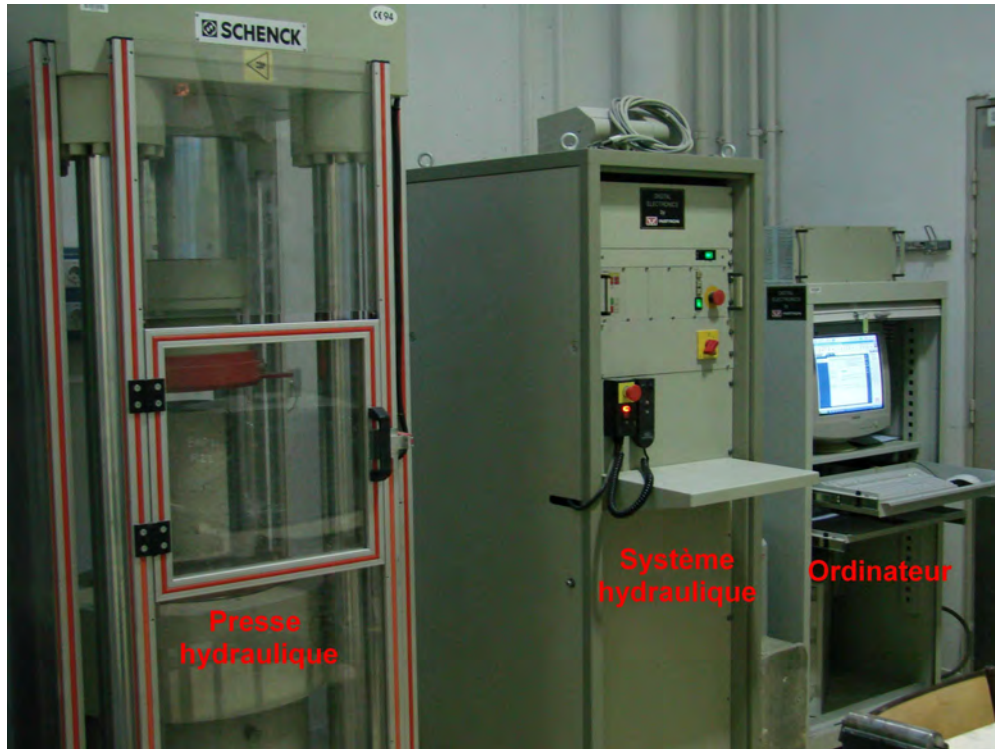
Figure 5.11 – Presse hydraulique utilisée
