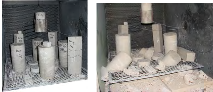
Figure 6.12 – Eprouvettes avant et après chauffage
