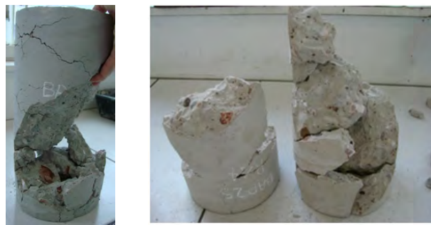
Figure 6.13 – Eprouvettes reconstituées après éclatement
