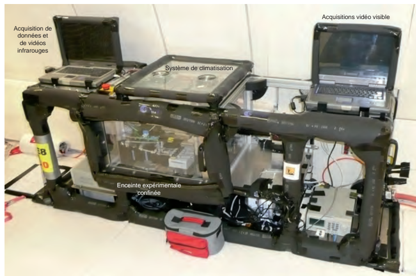
FIGURE 2.2 – Dispositif expérimental ABIMM utilisé pour les campagnes de vols paraboliques
