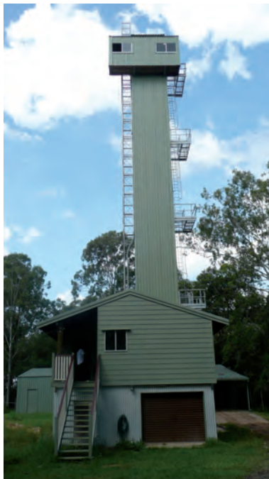
FIGURE 2.51 – Tour de chute libre de Brisbane, Australie : 25 mètre de haut pour 2.0 secondes de microgravité à 10^{-4}g .
