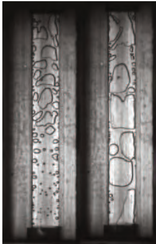
FIGURE 2.7 – Comparaison des structures d’écoulement observées au sein du minicanal d’épaisseur hydraulique de 454 \mu\text{m} ( Q_w = 32 \text{ kW}\cdot\text{m}^{-2} et Q_m = 0.19 \text{ g/s} )
