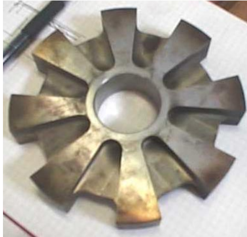
Figure 5.56 - Extrémité des dents du rotor massif après utilisation en moteur
